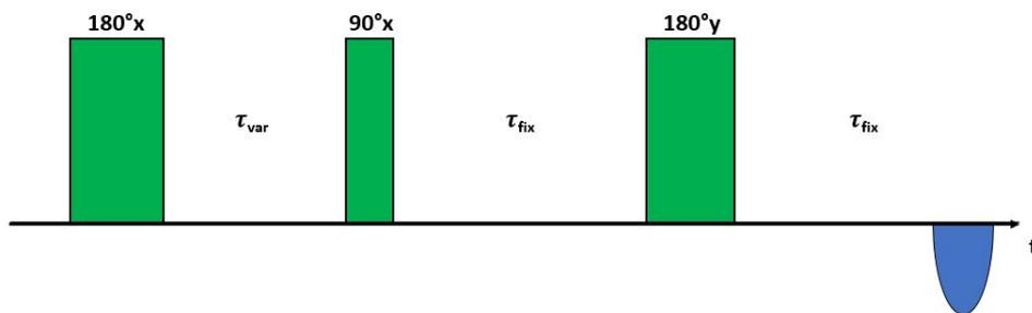
Mit Hilfe des Produktoperatorformalismus lässt sich die Evolution der Magnetisierung unter verschieden Operatoren entwickeln. Die Ausgangsmagnetisierung soll  $M_z$  sein. Berechnen Sie die Magnetisierung zum Zeitpunkt des Echos unter Entwicklung der Kohärenzen ( $\Omega_0 S_z$ ) und der transversalen Relaxation. Nehmen Sie an  $\tau_{\text{fix}} \ll T_1$  und gehen Sie von idealen Pulsen aus.
